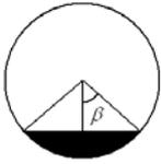
**Figura 1.2** Representación del ángulo  $\beta$ , con respecto al diámetro vertical y al área que ocupa el mineral dentro del cilindro.
