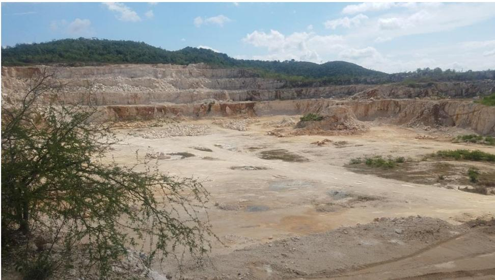
Figura 3.1 Sistema de explotación por bancos descendente de la cantera El Cacao.
