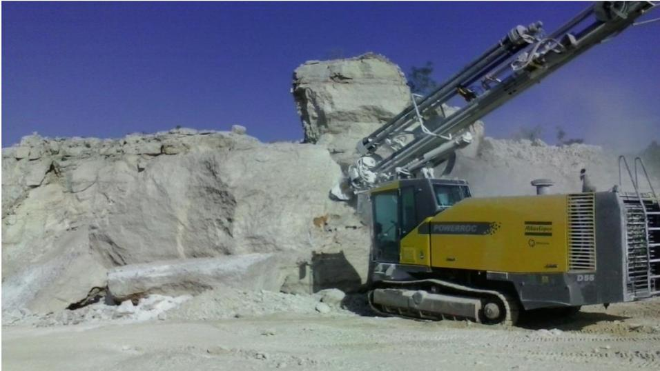
Figura 3.2 Carretilla barrenadora Altas Copco 460 PC
