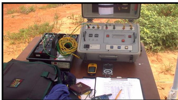
Foto 7 Georesistivímetro marca PASI, modelo E2 DIGIT
