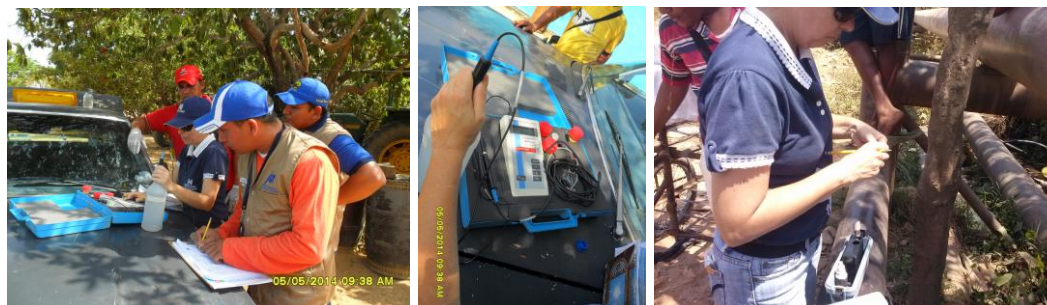
Figura14. Equipo de mediciones in situ, Potenciómetro (consort 530c), peachímetro.
