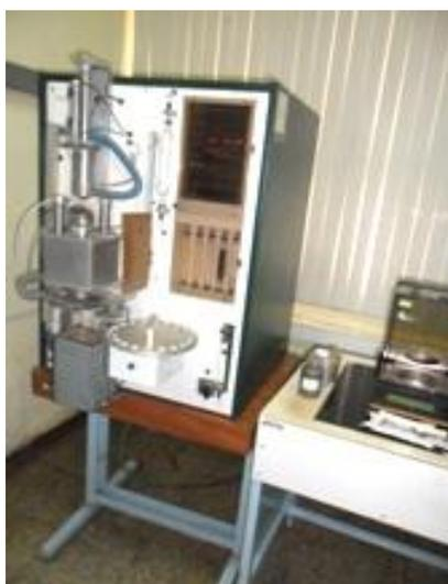
Figura 2. Electro analizador de azufre y carbono
