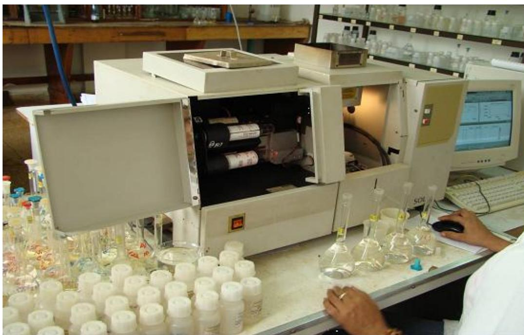
Figura 1. Espectrofotómetro de absorción atómica. Modelo UNICAM 929.
