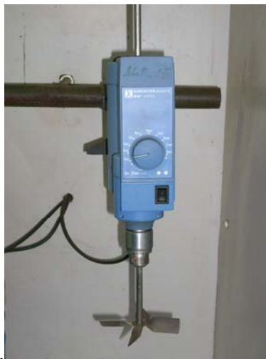
Figura 2.2. Agitador de velocidad variable experimental a escala de laboratorio.
