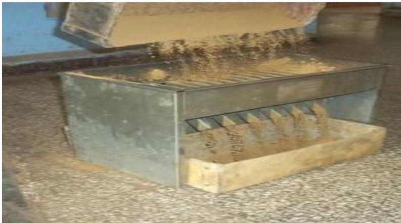
**Figura 2.** Procedimiento de homogenización
