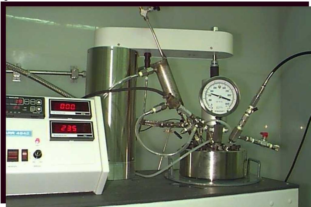
Figura 2.3 Instalación para pruebas de disolución del sulfuro de níquel y cobalto
