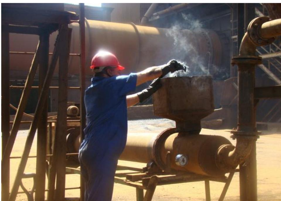
Figura 2.2. Instalación piloto utilizada para el secado de sulfuro de Níquel y cobalto utilizando gases residuales
