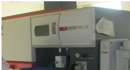
Figura 2.2: Espectrómetro de Emisión Óptica de Plasma Inductivamente Acoplado (ICP)
