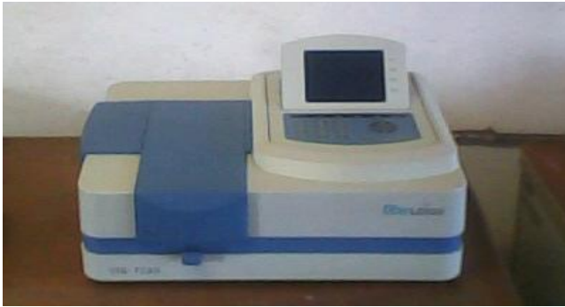
Figura 2.3: Espectrofotómetro UV-Visible Rayleigh.
