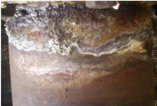
Figura 3.15. Corrosión en la línea de recirculación
