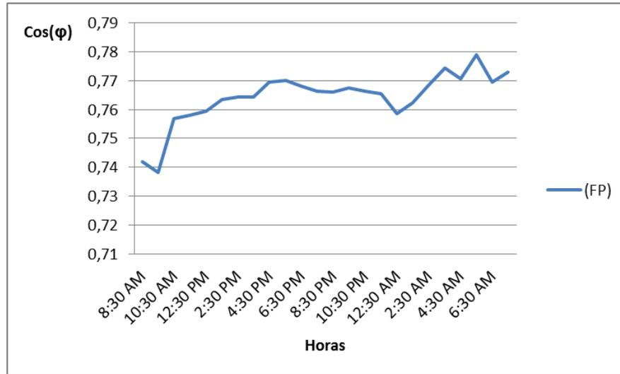
Figura 2.10: Factor de potencia en la segunda sección de 1TP-16
