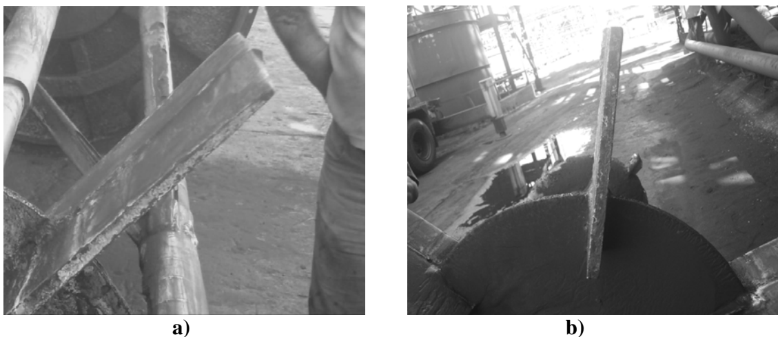
Figura 9. Comportamiento del desgaste en los impelentes después de 540 días de trabajo
