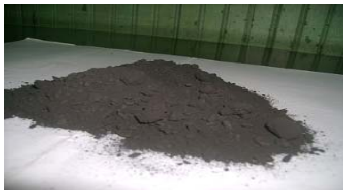
Figura 2. Muestra de mineral reducido seco utilizado en los ensayos de desgaste
