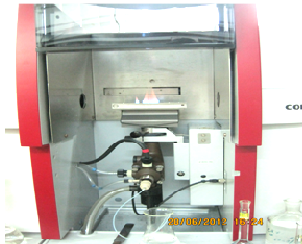
Figura 16. Efecto que se produce durante la nebulización en la llama.
