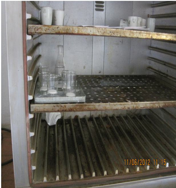
Figura 3. Estufa utilizada para eliminar humedad de la muestra.
