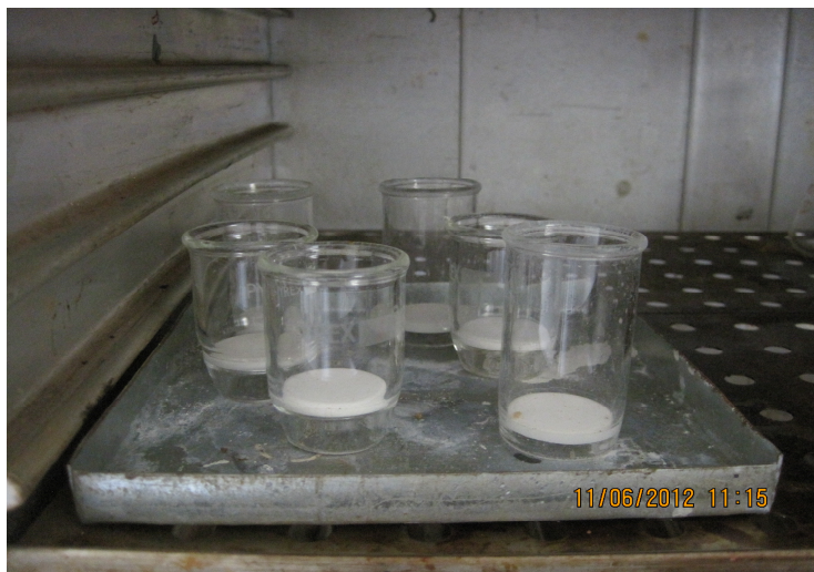
Figura 2. Crisol de fondo fritado utilizado para filtrar el precipitado.
