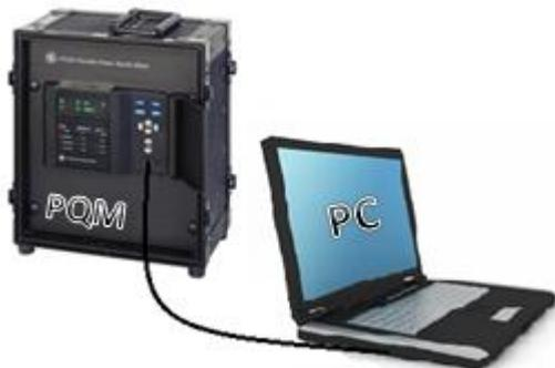
Fig. 2.7 PQM portátil usada en el monitoreo
