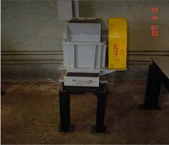
Fig. 2.5. Trituradora de mandíbula utilizada para realizar los experimentos.
