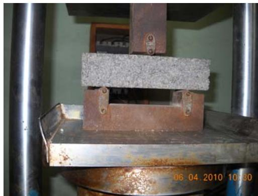
Figura 7. Fotografía ensayo para resistencia a la flexión de morteros.
