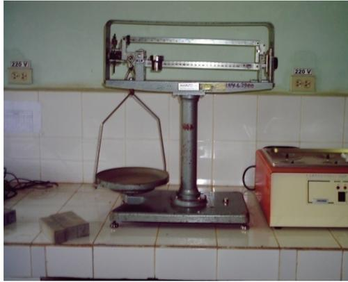
Figura 5. Balanza Hidrostática
