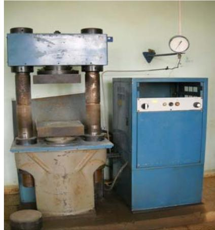
Figura 4. Fotografía prensa empleada para el ensayo de resistencia para bloques.
