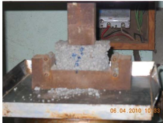
Figura 6. Fotografía ensayo para resistencia a compresión de morteros.
