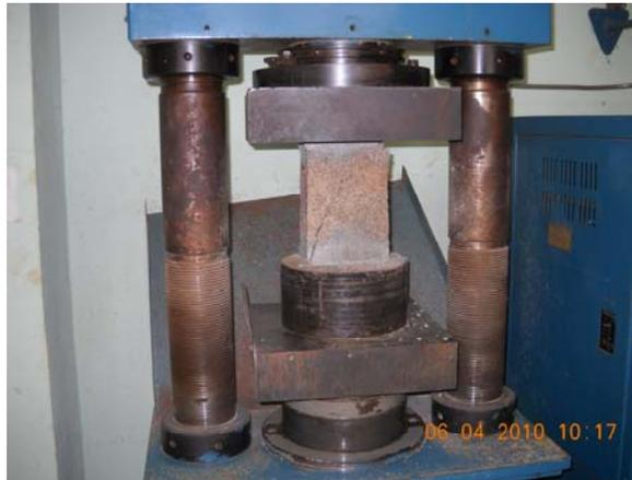
Figura 5. Fotografía ensayo de resistencia a compresión para los bloques obtenidos con material de desechos sólidos.
