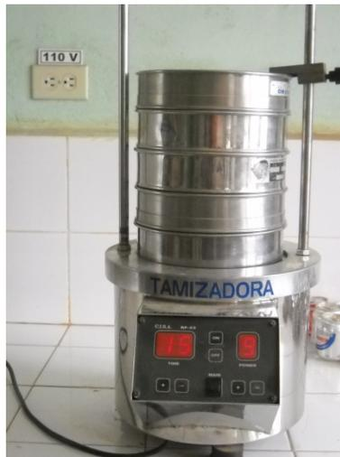
Figura 3. Tamizadora Eléctrica
