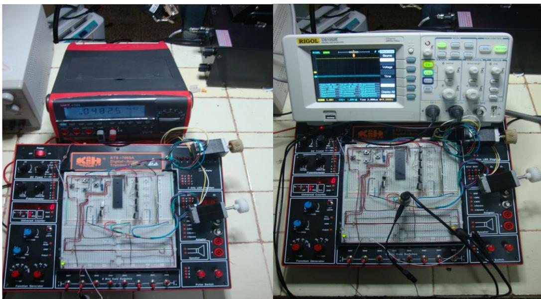
Figura 3.3. Mediciones realizadas con el multímetro (izquierda) y el osciloscopio (derecha) al circuito del seguidor solar.
