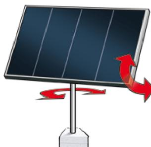
Figura 2.21. Ejemplo de estructura mono-poste.
