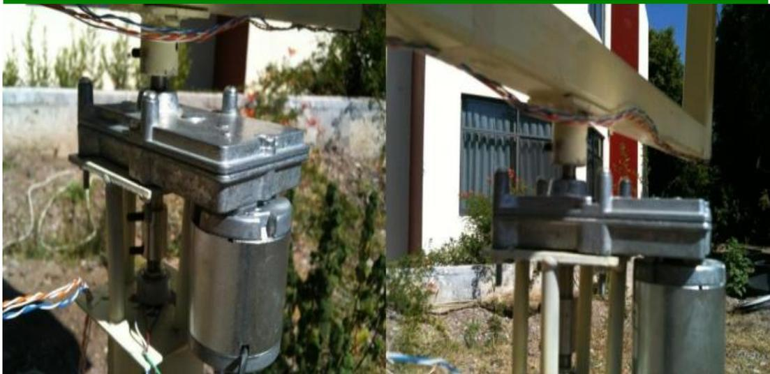
Figura 2.23. Módulo de motores acoplados a los reductores.
