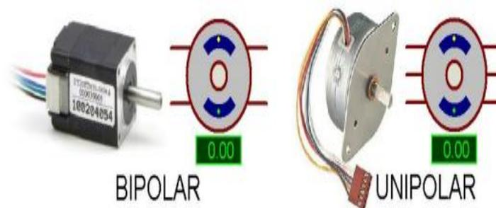
Figura 2.17. Apariencia física y vista en el simulador ISIS de los motores de paso.
