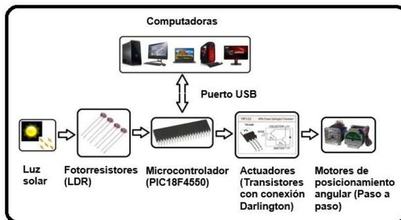
Figura 2.1. Principio de funcionamiento del sistema de seguimiento solar.
