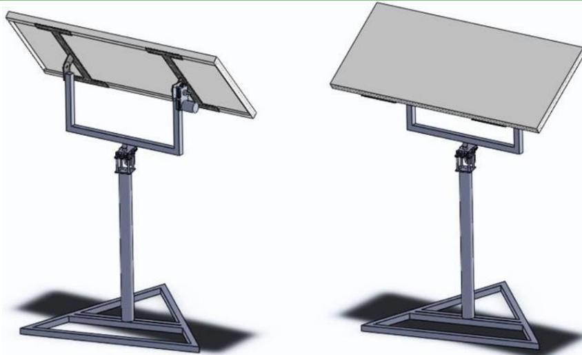
Figura 2.24. Estructura del seguidor solar.
