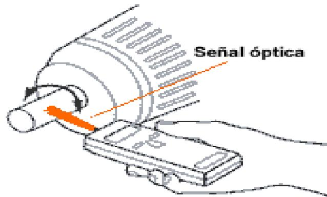
Fig. 1.9. Esquema de medición del tacómetro óptico
