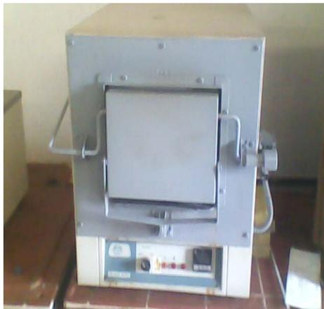
Figura 2.2 Horno eléctrico de laboratorio
