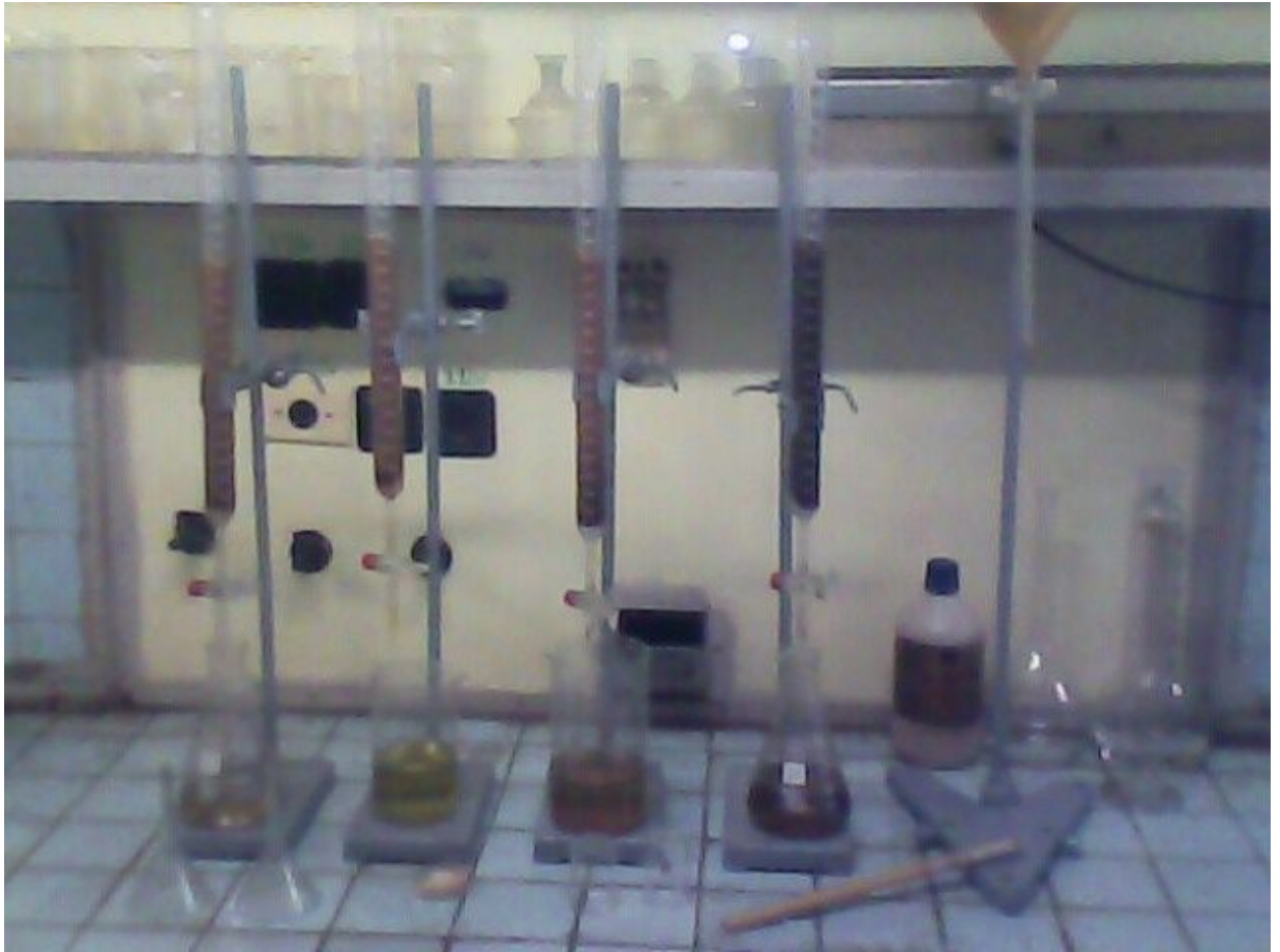
Figura. 2. Foto del esquema de la instalación para el proceso de intercambio iónico
