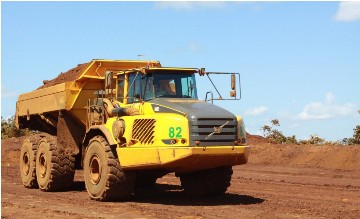
Figura 2.3 Camión Bell: camiones utilizados actualmente en el Tiro de Mineral en las Minas de la Empresa.
