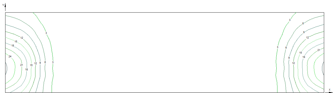
Figura 23 Diagrama isolux del tramo escogido de la calzada.
