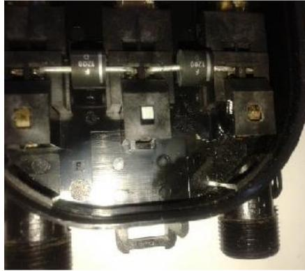
**Fig.1.14- Caja de conexión con diodos, en placas solares.**
