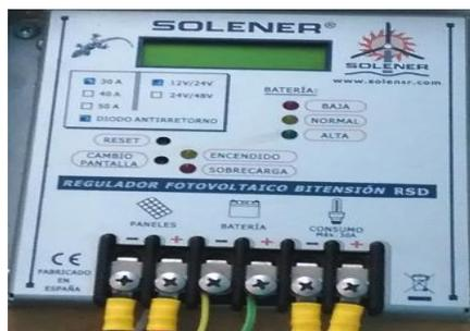
Fig.2.3- Regulador fotovoltaico Solener RSD 30A 12-24 voltios.
