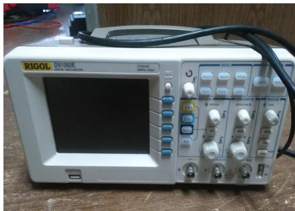
Fig.2.7- Osciloscopio Digital Rigol DS1052E.
