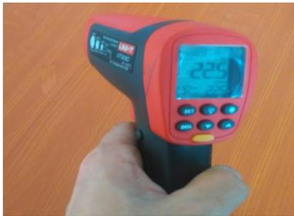
Fig.2.5- Pirómetro infrarrojo UNI-T UT301C.
