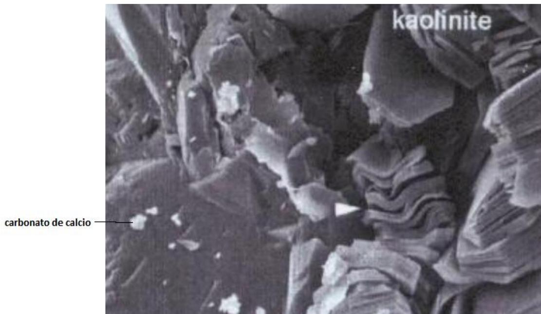
Figura 3.7 Estructura microscópica de la arcilla.
