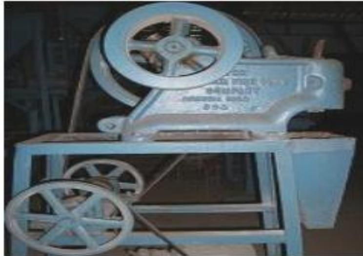
Figura 2.3 Trituradora de mandíbulas.
