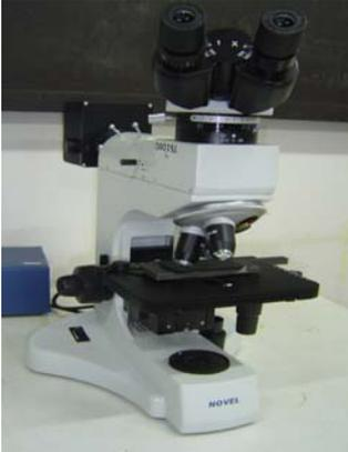
**Figura 2.3. Microscopio Óptico NOVEL modelo NIM-100.**
