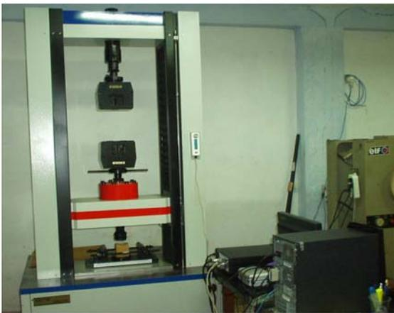
**Figura 2.6. Máquina de análisis de los ensayos de resistencia DNS 200**
