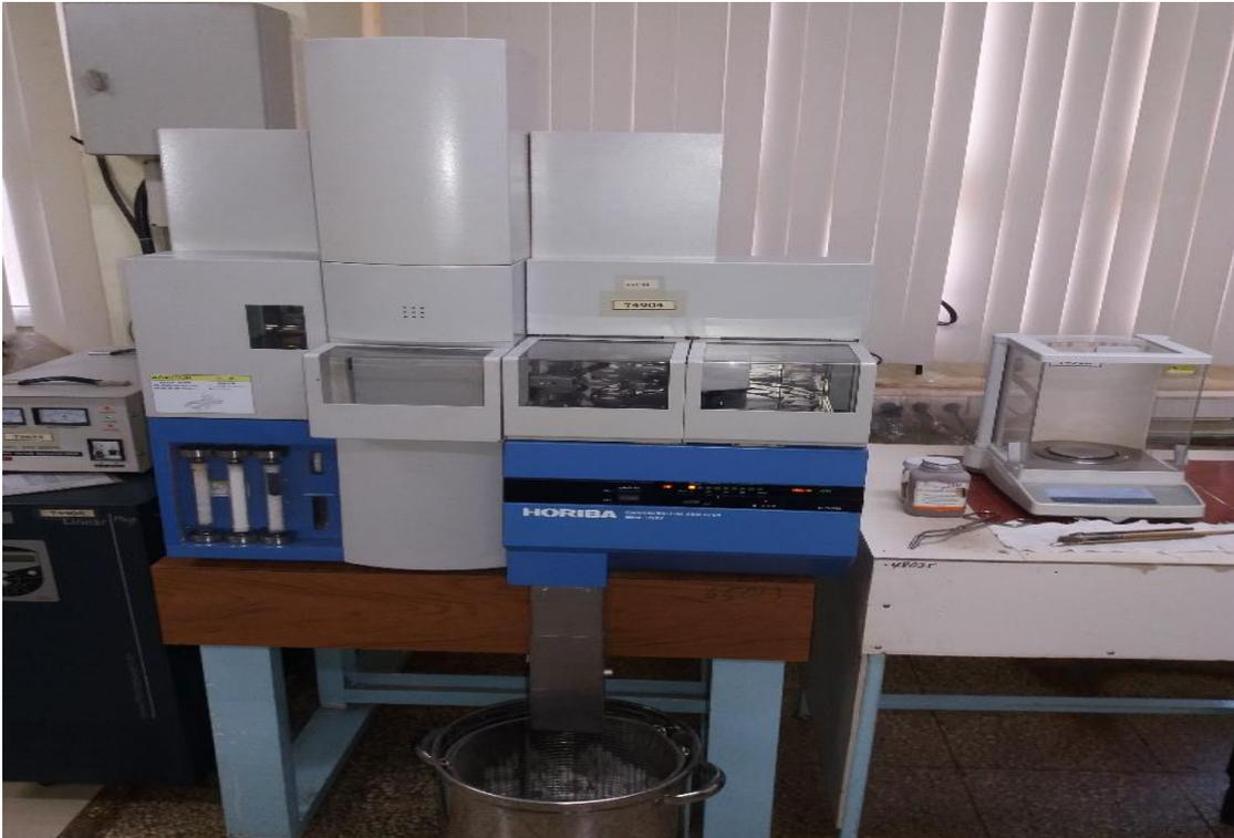
**Figura 14** Analizador infrarrojo automático
