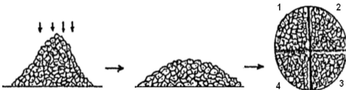
**Figura 3** Método de cuarteo de cono y anillo para la homogenización de la muestra
