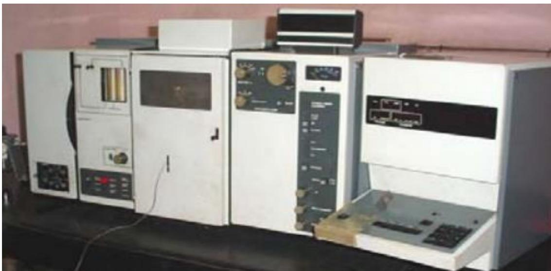
**Figura 13** Equipo de Espectrofotometría de Absorción Atómica (SP-9)
