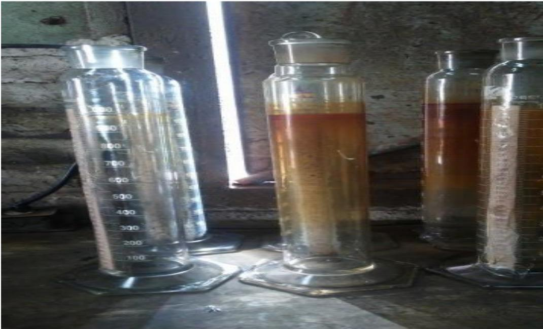
**Figura 12** Probetas que se utilizan para la sedimentación
