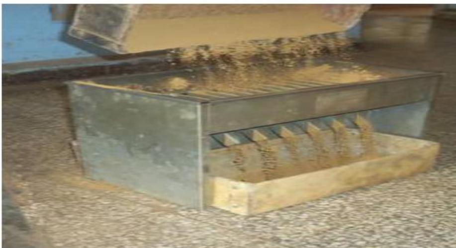
**Figura 4** Divisor Acanalado para la homogenización y el cuarteo de las muestras
