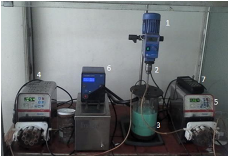
Figura 2.1 Instalación experimental utilizada para la obtención de hidróxido de níquel(II)
