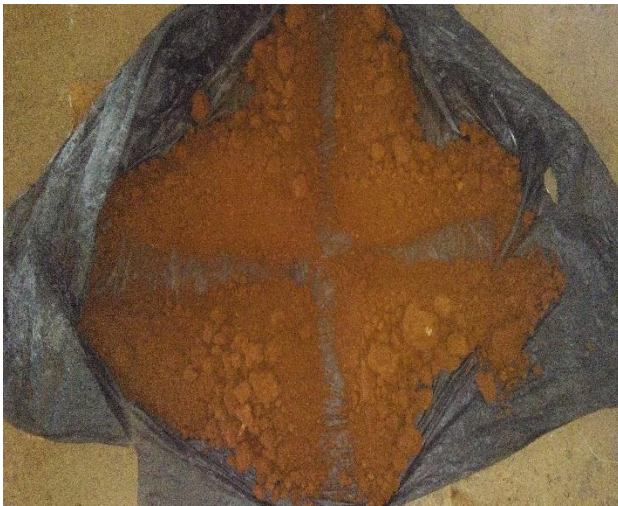
Figura 2.1 Muestra cuarteada realizado a los escombros lateríticos del yacimiento Camarioca Norte, Zona 12.
