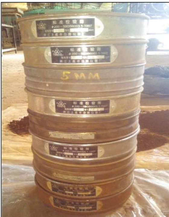
Figura 2.3 Tamices utilizados en el análisis granulométrico
