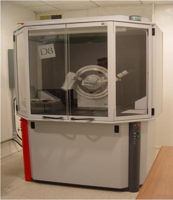
Figura 2.7 Difractómetro de rayos-X utilizado para la caracterización mineralógica de la muestra.
