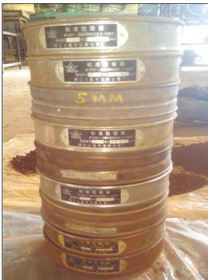
**Figura 5.** Juego de tamices utilizados en el análisis granulométrico
