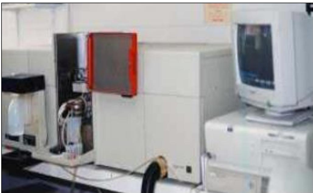
**Figura 7.** Equipo de Espectroscopia de Absorción Atómica empleado en la caracterización química.
