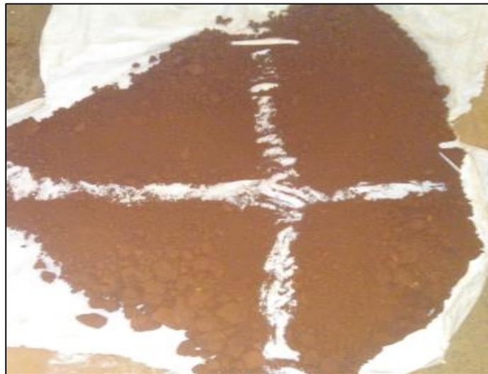
**Figura 3.** Procedimiento del cuarteo manual realizado a los escombros lateríticos del yacimiento Moa Occidental.
