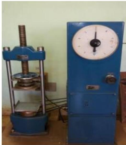
Figura 2.3. Prensa hidráulica empleada para los ensayos de resistencia a la compresión
