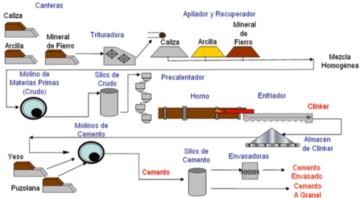
Figura 1.1. Proceso de obtención del cemento Portland. Fuente: <http://www.canacem.org.mx/>
