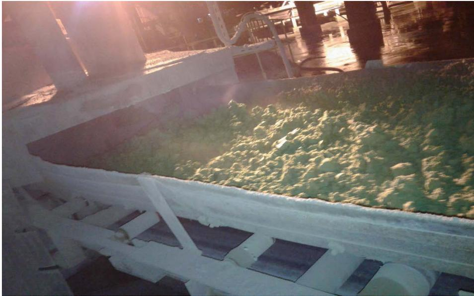
**Figura 2.1** Carbonato básico de níquel filtrado alimentado al horno de tambor rotatorio.
