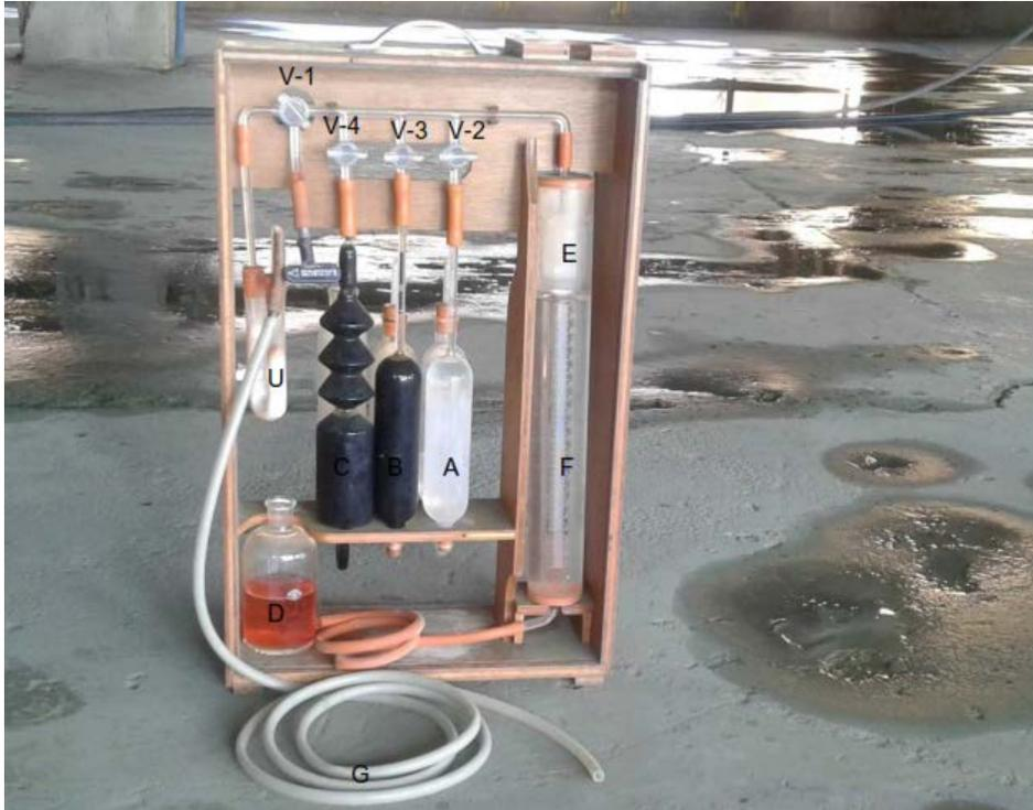
**Figura 2.9** Equipo Orsat para analizar los gases de combustión.
