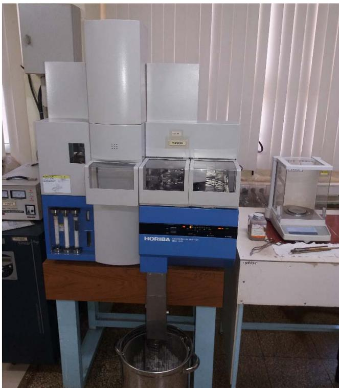
**Figura 2.11** Analizador infrarrojo automático marca HORIBA con balanza analítica acoplada.
