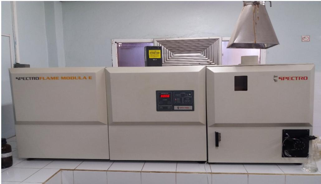
**Figura 2.12** Espectrofotómetro de absorción atómica con cátodo hueco.
