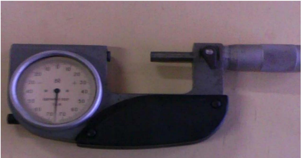
**Figura 6. Ilustración del micrómetro indicador**
