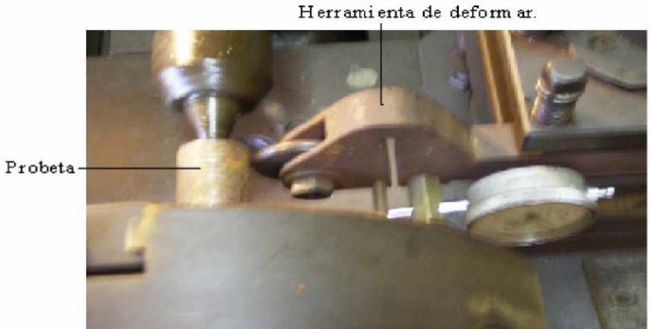
Figura 2 Ilustración de la operación de deformación plástica, en un torno 16 D 20 del ISMM (Fernández *et al.*, 2009).
