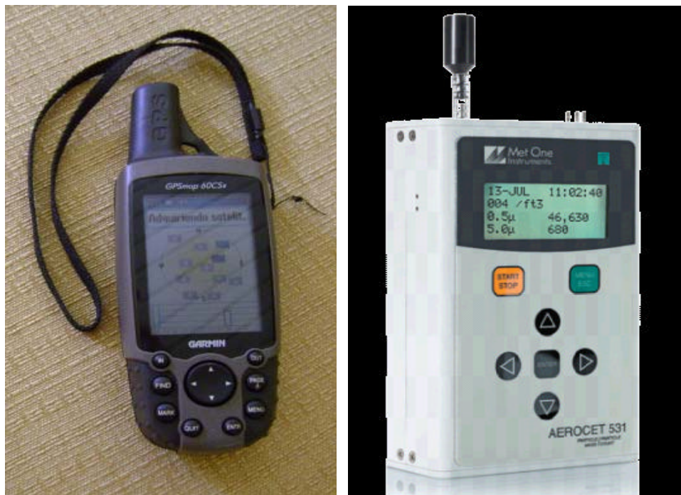
Figura 2.8 y 2.9. GPS Portátil y Equipo para determinar material particulado
