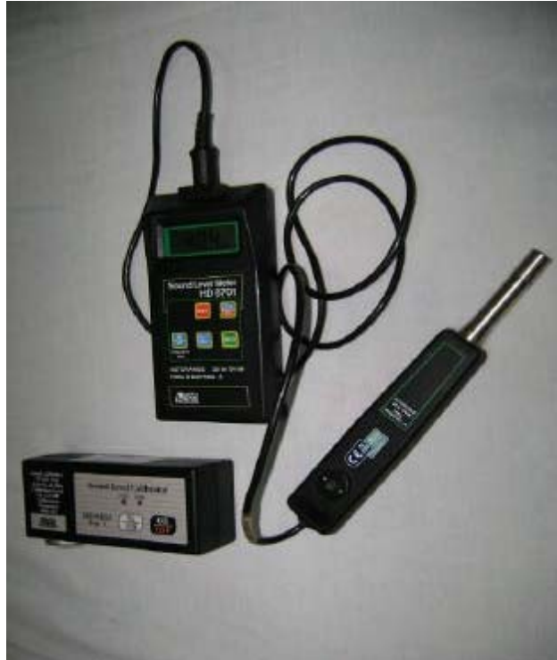
Figura 2.11. Sonómetro utilizado en las mediciones de ruido ambiental.
