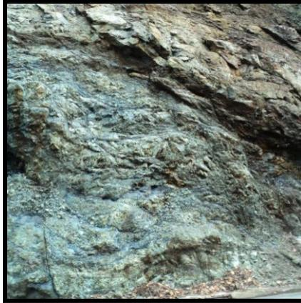
Fig. 47 Agrietamiento moderado.
