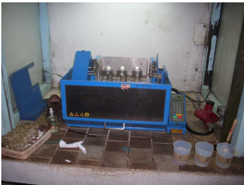
Foto. No. 1. Fundición de las muestras para análisis químico en el laboratorio Elio Trincado de Santiago de Cuba.
