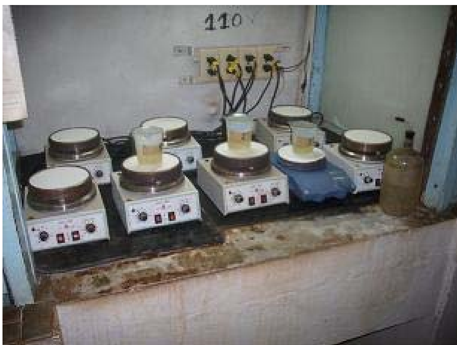
Foto No. 2. Preparación de las soluciones de las muestras para su análisis en el equipo de espectroscopia de masa con ICP acoplado, en el laboratorio Elio Trincado de Santiago de Cuba.
