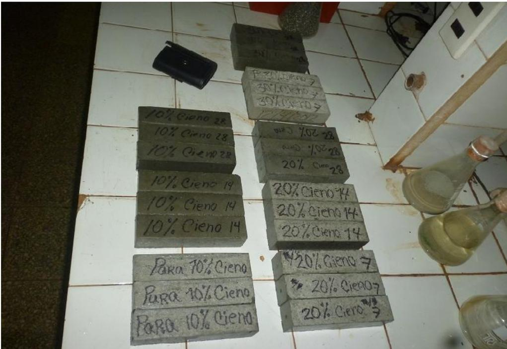
Figura 2. Morteros realizados a diferentes dosificaciones para sus análisis de compresión y flexión.
