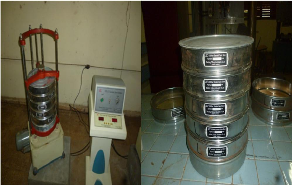
Figura 2.3. Tamizadora eléctrica y sus tamices que se utilizaron durante la investigación.
