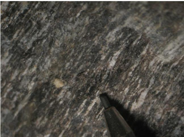
**Figura 3.2** Estructura gnéisica en anfibolita gnéisica.
