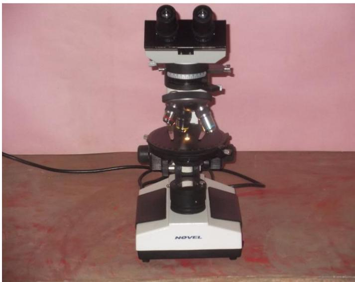
**Figura 2.1** Microscopio de luz polarizada modelo NP-400B, marca NOVEL.
