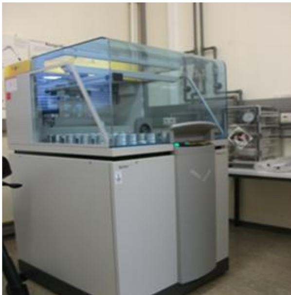
**Figura 2.2** Equipo de fluorescencia de rayos-X, marca Axios.
