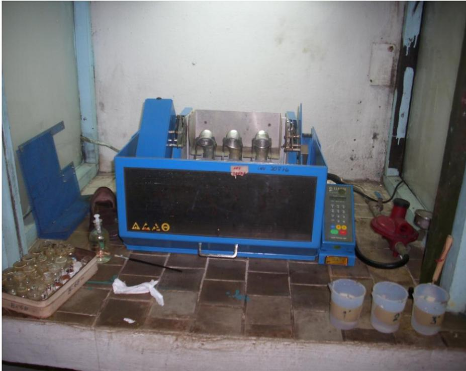
Figura 1.4: Fundición de las muestras para análisis químico en el laboratorio "Elio Trincado" de Santiago de Cuba.
