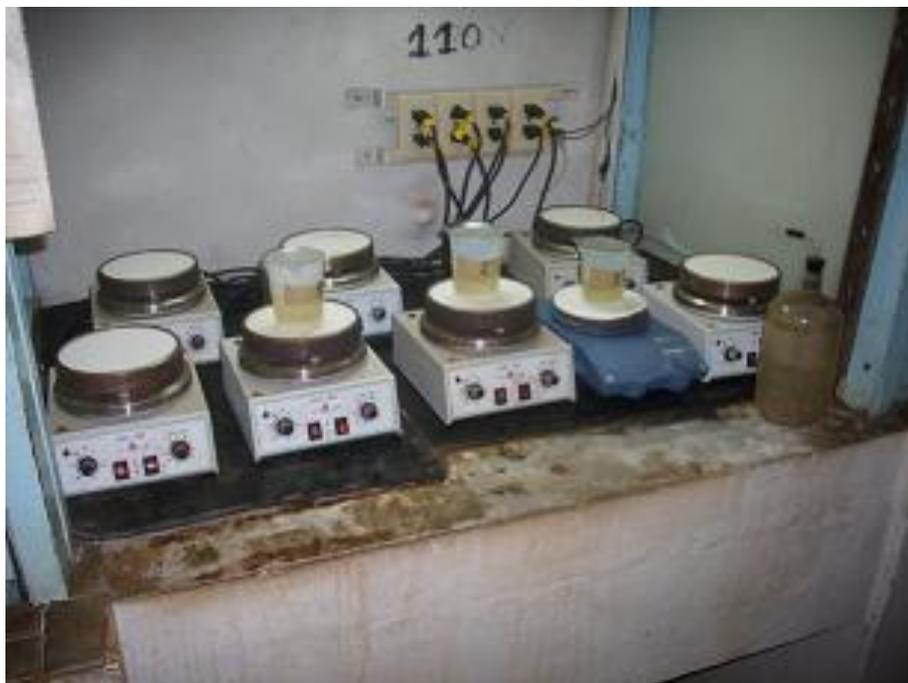
Figura 1.5: Preparación de las soluciones de las muestras para su análisis en el equipo de espectroscopia de masa con ICP acoplado, en el laboratorio de “Elio Trincado” Santiago de Cuba.
