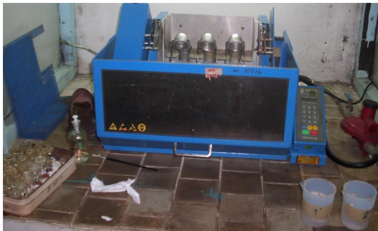
Figura 12. Fundición de las muestras para análisis químico en el laboratorio “Elio Trincado” de Santiago de Cuba.
