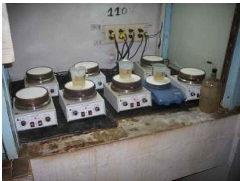
Figura 13. Preparación de las soluciones de las muestras para su análisis en el equipo de espectroscopia de masa con ICP acoplado, en el laboratorio de “Elio Trincado” Santiago de Cuba.
