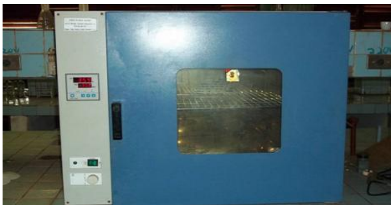
Figura 2.8. Estufa DHG 9146A con rango de temperatura de 0 – 400 °C.
