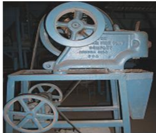
Figura 2.5. Trituradora de mandíbulas TQ (150x75)
