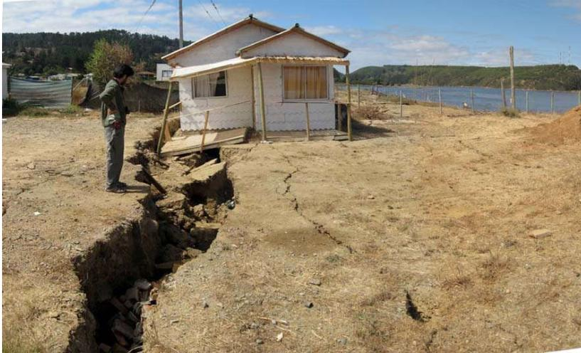
Figura. 2. Grietas, provocadas por licuefacción del terreno.
