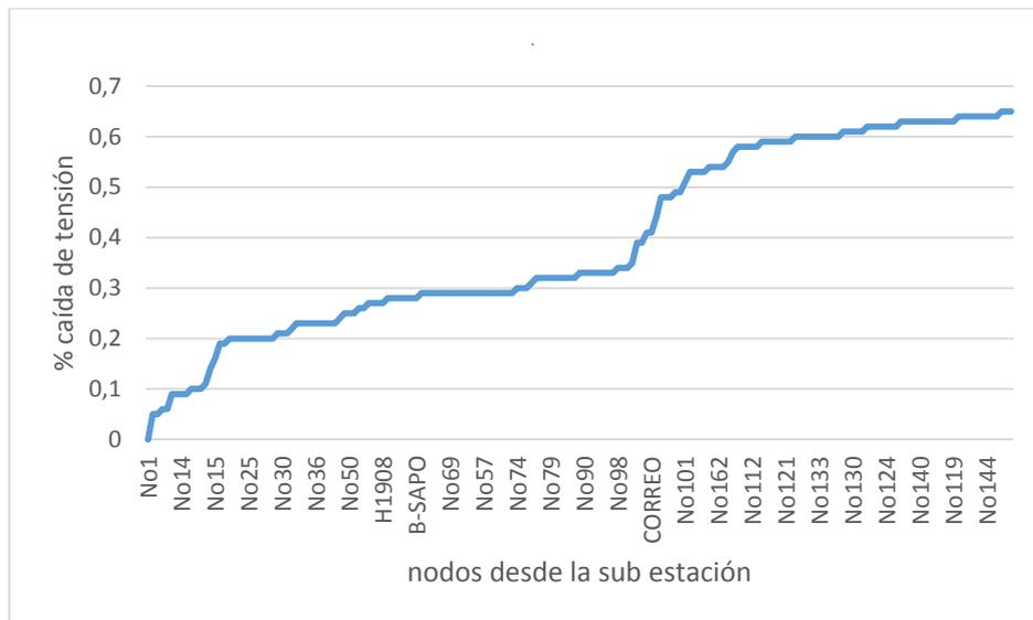
Figura 3.4 Caída de tensión en los nodos de mayor incidencia para el circuito 1 en %.
