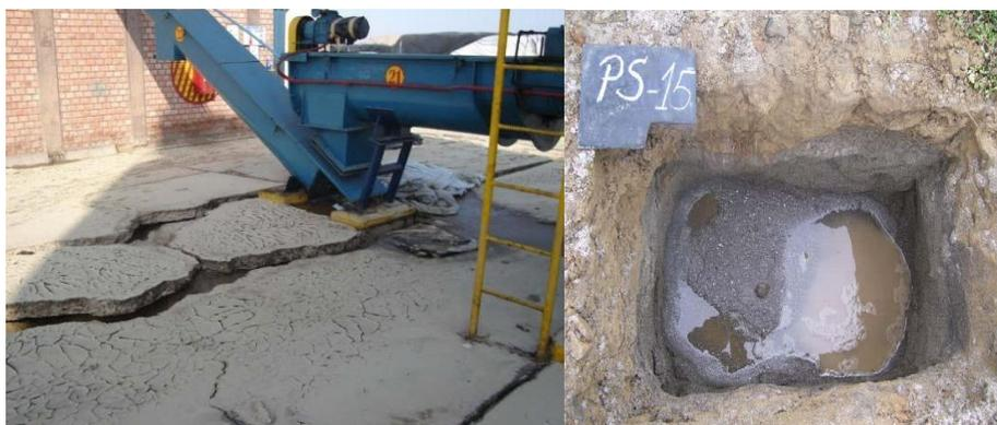
**Figura 3.** Evidencia de licuación de suelos, tipo de suelo y posición del nivel de agua en las zonas críticas de licuación.
