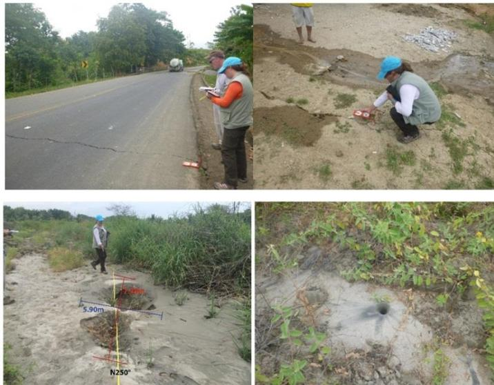
**Figura 9.** Personal del IGEPN e IRD realizando levantamiento geológico en el campo en las zonas entre Esmeraldas y Manta semana (19 al 23 de abril del 2016). En las fotos se observan grietas y “volcanes de arena” producto de licuefacción.
