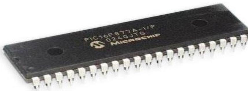
Figura 2.6. Encapsulado del PIC16F877A.
