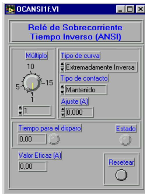
Figura 2.3.2.0. Ventana Panel del Relé de Sobrecorriente según ANSI.
