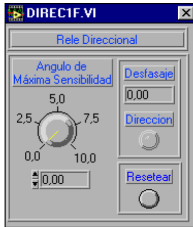
Figura 2.3.1.0. Panel de los Relés Direccionales Monofásicos.
