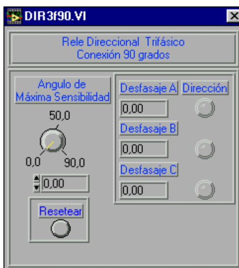
Figura 2.3.1.4. Panel del Relé Direccional de Potencia Trifásico.
