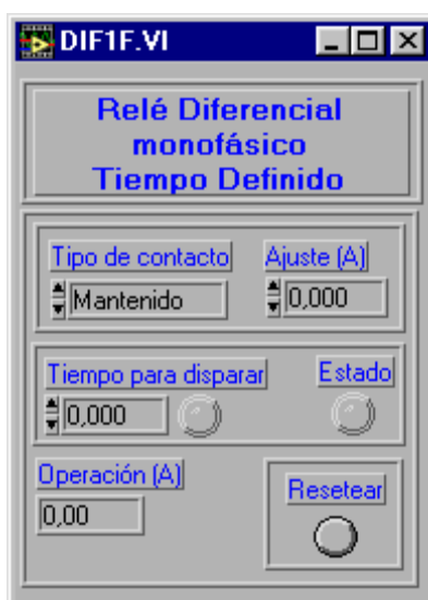
Figura 2.3.3.0. Panel Frontal del Relé Diferencial Instantáneo.
