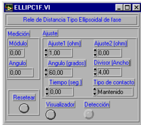
Figura 2.3.3.4. Panel Frontal de los Relés de Distancia del tipo Elipsoidal.
