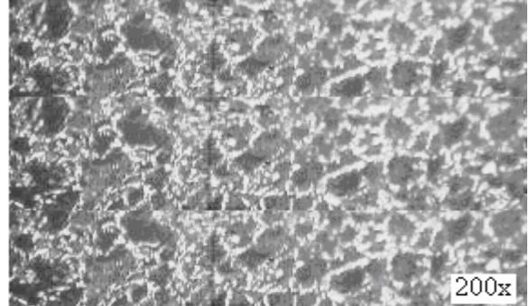
Figura b. Deformada con  $P = 2\ 500\ \text{N}$ ;  $S = 0,075\ \text{mm/rev}$  y  $n_r = 27\ \text{rev/min}$ .
