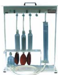
Fig. 3: Equipo Orsat para determinación de CO 2 .
