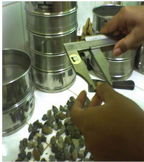
Fotografía 6. Determinación de partículas planas y alargadas con el pie de rey.
