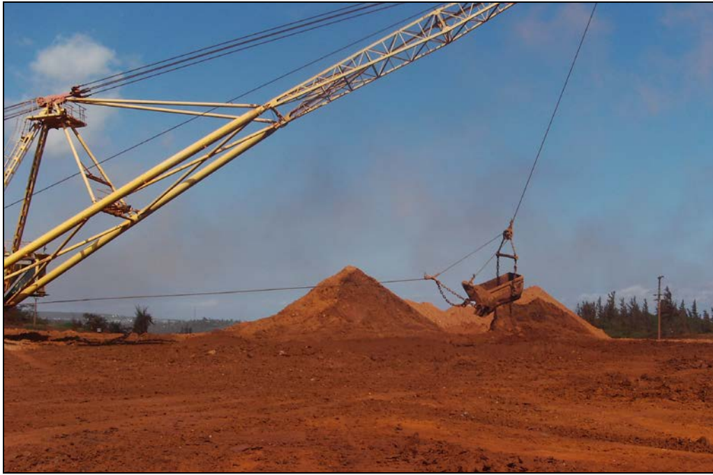
Figura # 2.7 Conos remontados con excavadoras Dragalinas ESH – 5/45 desde el piso, desde la cima de la pila o desde uno de los taludes de la propia pila
