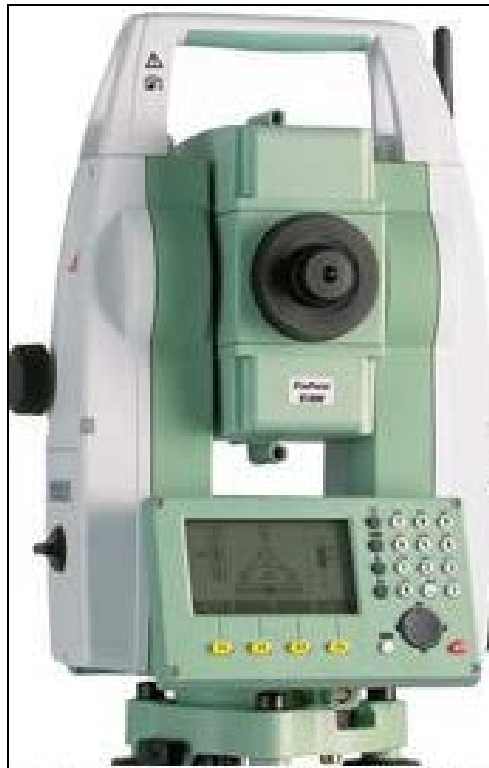
Figura # 3.1 Estación Total Leica TCR – 803 utilizada en el levantamiento topográfico
