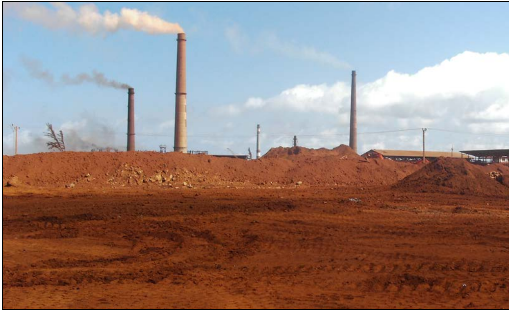
Figura # 2.5 Pilas lineales remontadas con cargadores frontales o retroexcavadoras
