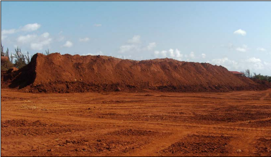
Figura # 3.5 Beneficio y remoción con cargador frontal sobre lotes en plazoleta lateral de abasto para apilado con retroexcavadora a talud de secado natural y evacuación con alternativa libre (Pila patrón de la variante seleccionada).
