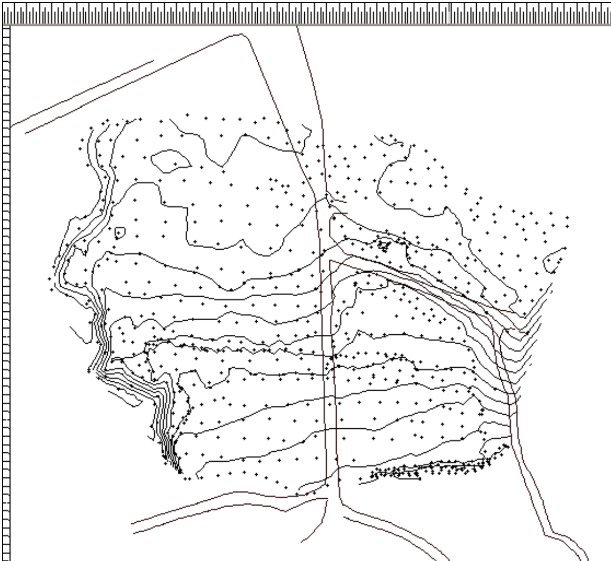
Figura # 3.3 Representación de los puntos del levantamiento y curvas de nivel del depósito
