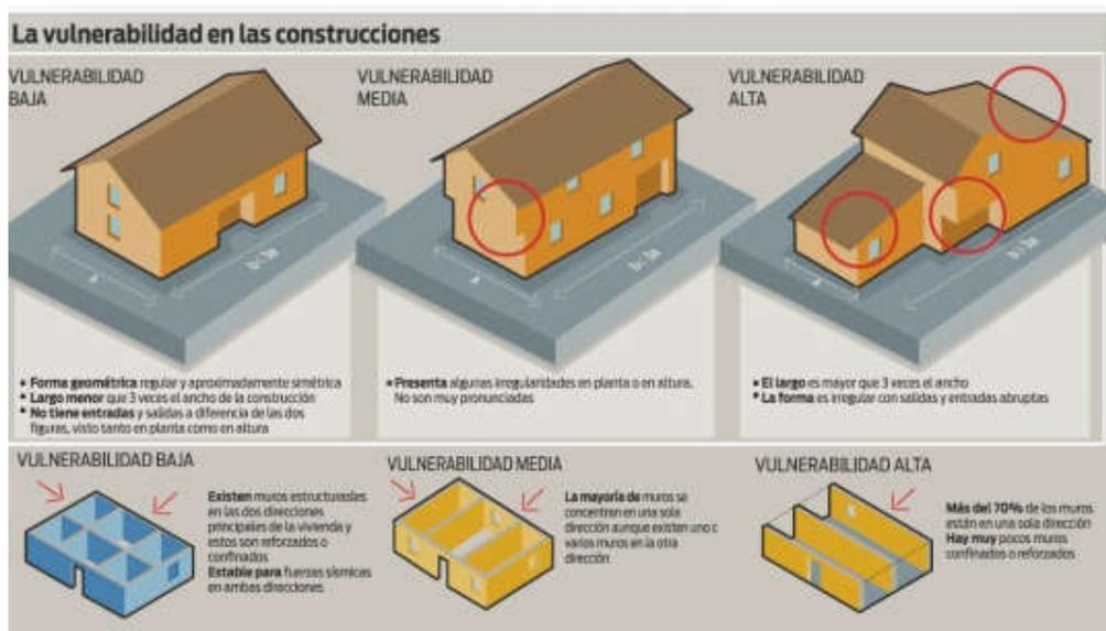
Figura 3.14 Esquema de vulnerabilidad en las estructuras.
