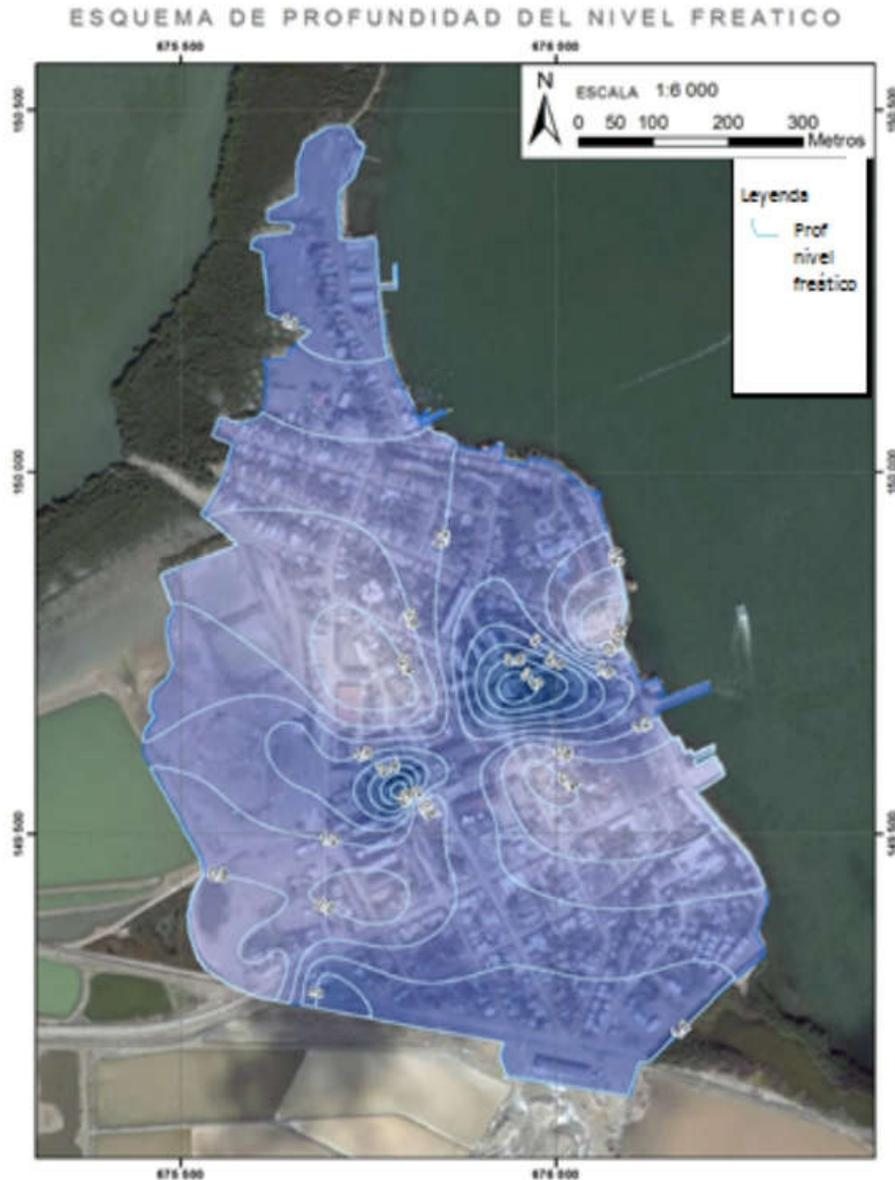
Figura 3.5 Esquema de profundidad del nivel freático en el municipio Caimanera, provincia Guantánamo. Tomado de Fernández, 2015.
